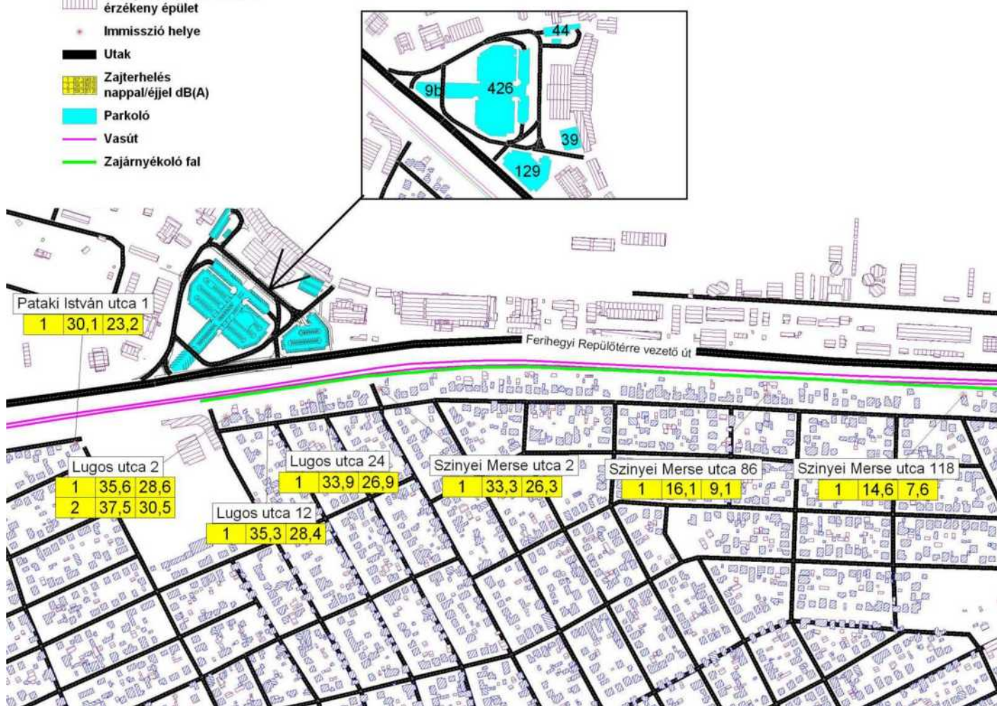
Közlekedési zaj alakulása a vasúti zajvédő fal árnyékában a Szemeretelepen (forrás: Vibrocomp, 2013)
